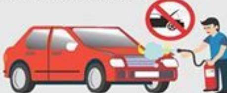
กรณีมีเปลวไฟออกมาจากฝากระโปรง ให้ปิดสวิตช์ฝากระโปรง และใช้ถังดับเพลิงเคมีฉีดพ่นผ่านช่องฝากระโปรงที่แง้มไว้ ห้ามเปิดฝากระโปรงในทันที เพราะจะทำให้ ไฟลุกลามมากขึ้น
